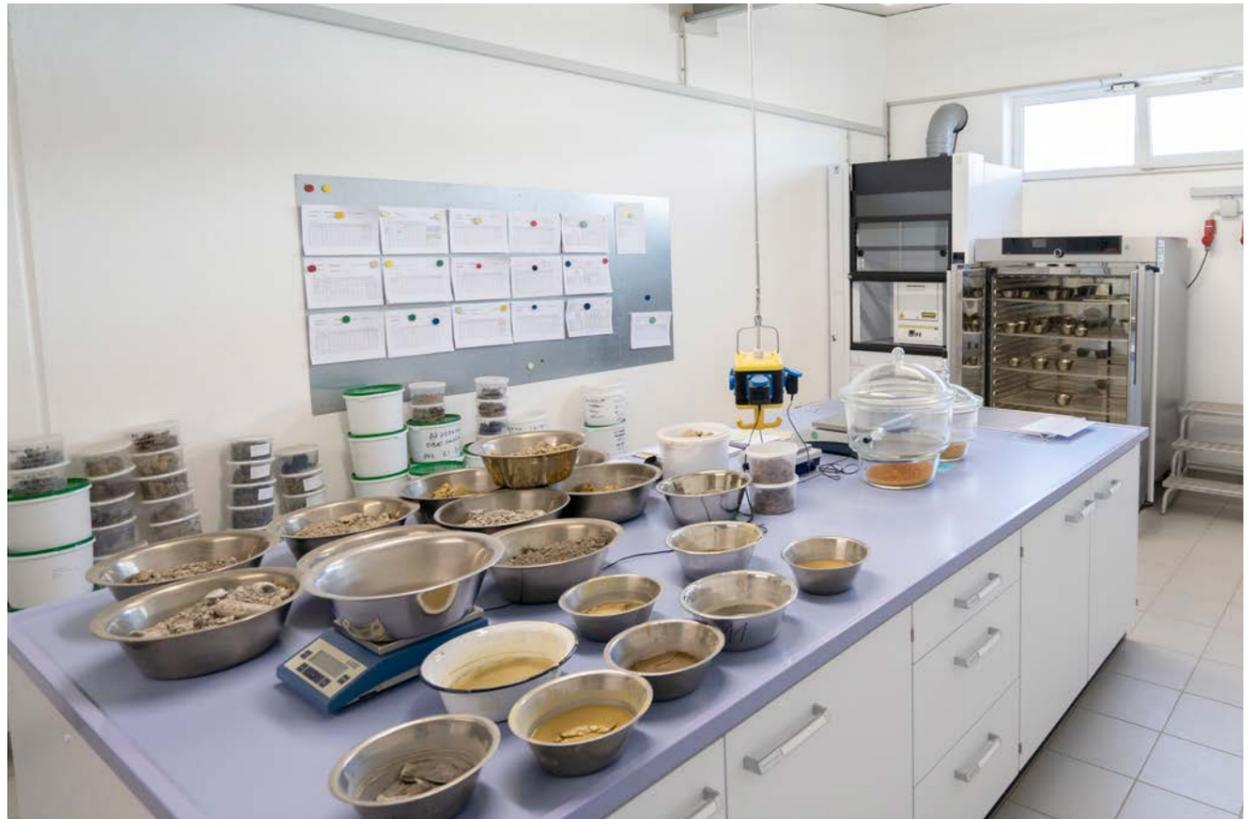
Muffelofen (hinten links im Bild) rechts daneben der Trockenschrank
