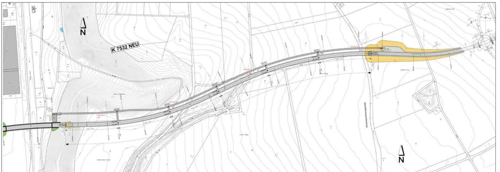
Planung Tunnelführung mit Gerätehaus-Bohrpunkte zur Erkundung Tunnelstrecke
