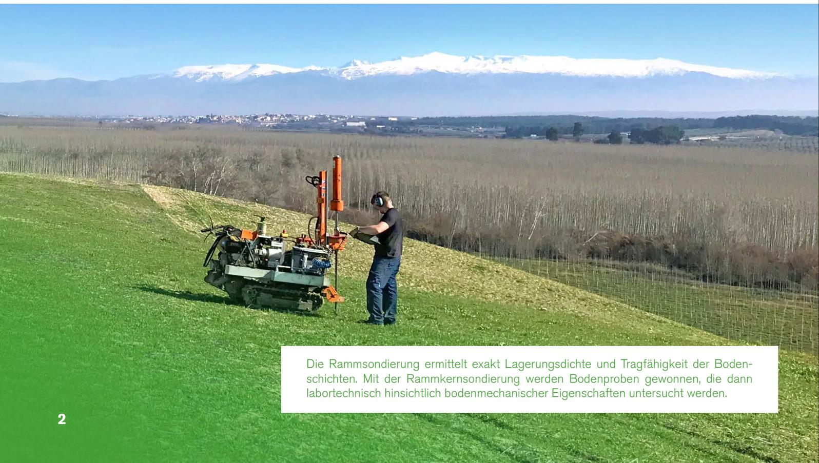
Die Rammsondierung ermittelt exakt Lagerungsdichte und Tragfähigkeit der Bodenschichten. Mit der Rammkernsondierung werden Bodenproben gewonnen, die dann labortechnisch hinsichtlich bodenmechanischer Eigenschaften untersucht werden.
