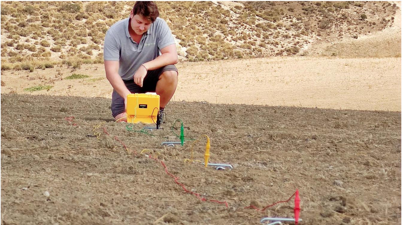
Der spezifische Bodenwiderstand wird über in-situ Versuche mit einem Widerstandsgerät ermittelt.
