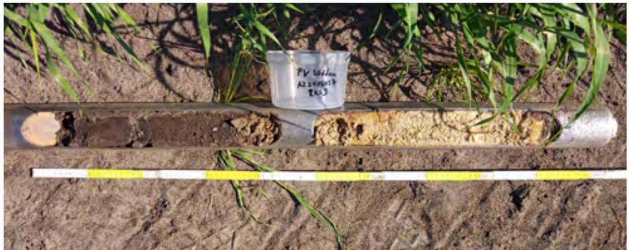
Bodenproben sind sinnvoll, um die geotechnischen Eigenschaften exakt zu bestimmen. Wir bewerten den Boden an der Bohrstelle und unsere Geowissenschaftler ermitteln in unserem hauseigenen Labor bodenmechanische und physikalische Kennwerte. Darüber hinaus wird die Korrosionswahrscheinlichkeit und die damit einhergehende notwendige Beschaffenheit der Metallträger analysiert.
