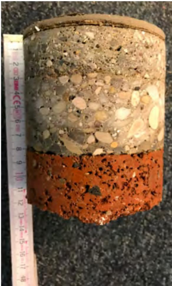
Bohrkern aus dem Fußbodenaufbau
