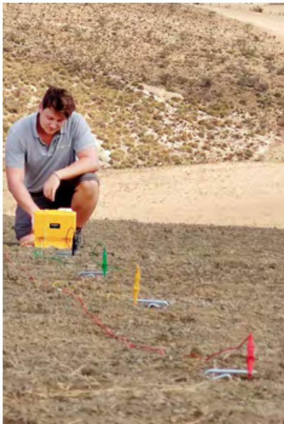
Der spezifische Bodenwiderstand wird über in-situ Versuche mit einem Widerstandsgerät ermittelt.
