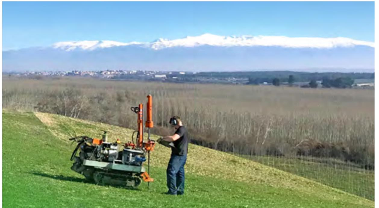
Die Rammsondierung ermittelt exakt Lagerungsdichte und Tragfähigkeit der Bodenschichten. Mit der Rammkernsondierung werden Bodenproben gewonnen, die dann labortechnisch hinsichtlich bodenmechanischer Eigenschaften untersucht werden.
