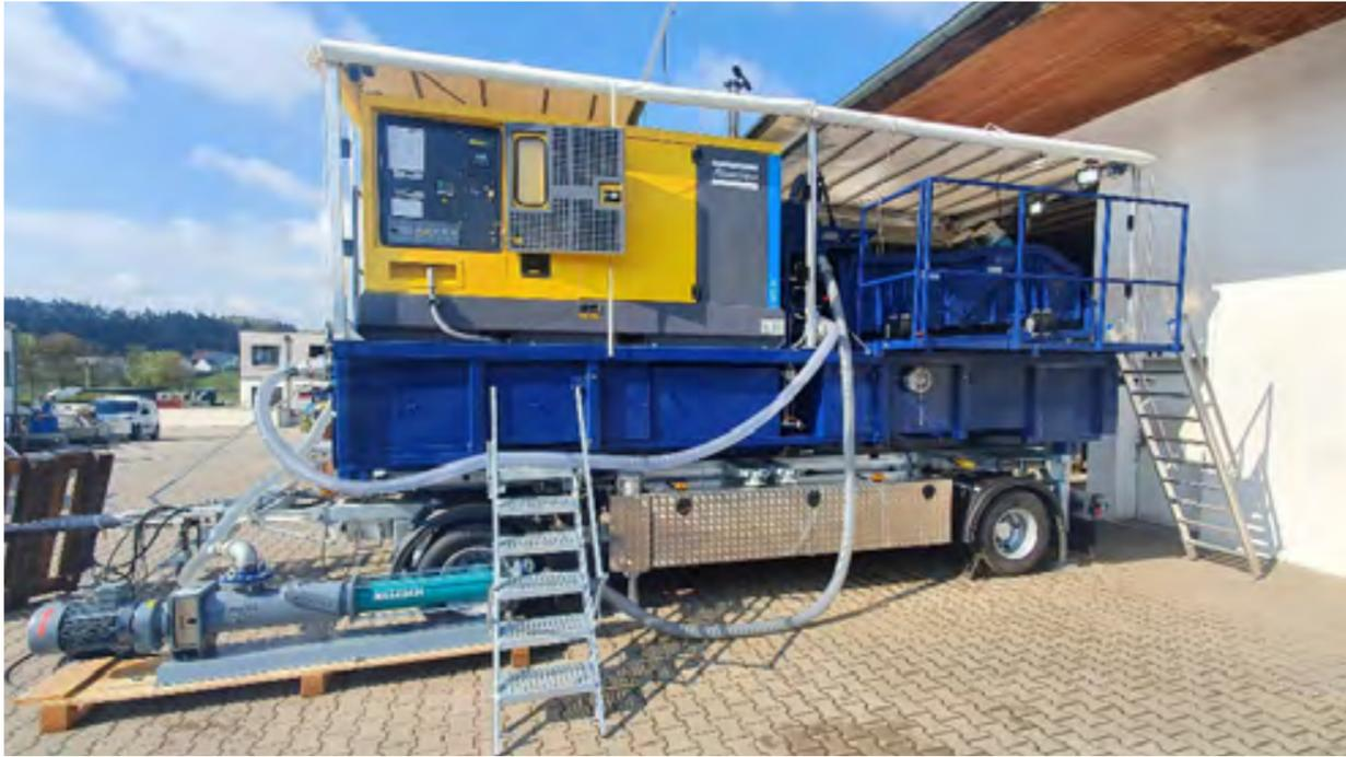
**Separationsanlagen zur Aufbereitung von Bohrschlamm.**
