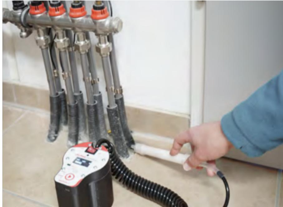
Aktive Messung mit Radon Sniffer im Zuge einer Objektbegehung.
